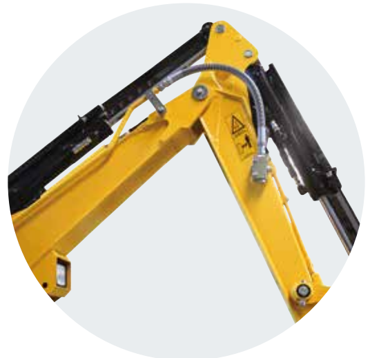
アームエンド配管
